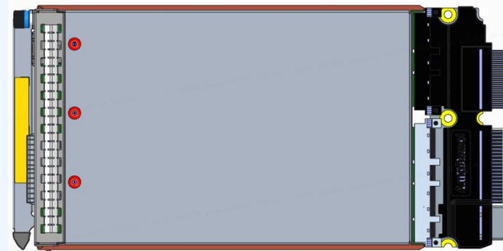
DPU卡与主板连接物理结构示意图
